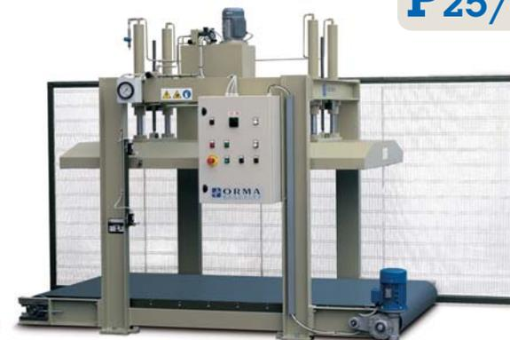
Pressa a freddo modello PFL versione economica. A seguito di specifiche richieste del cliente è stata realizzata una pressa a freddo con una pressione di lavoro non superiore ad 1 kg/cm<sup>2</sup> ma nello stesso tempo completa di un sistema di avanzamento, a mezzo tappeto, del materiale da pressare.
