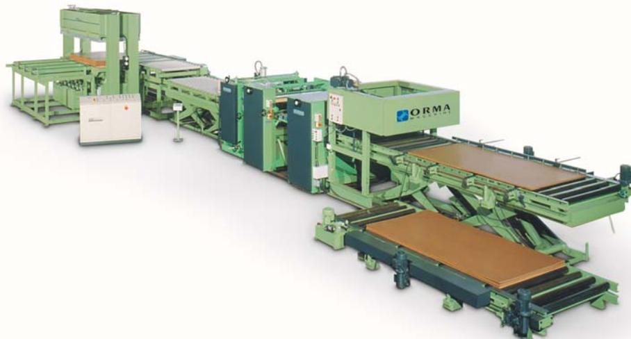
Impianto speciale per la nobilitazione di pannelli di spessore sottile con laminati e/o carte. L'installazione prevede una zona di alimentazione, con introduttore a depressione, gruppo di spazzolatura, spalmatura della colla e rivestimento simultaneo, superiore ed inferiore, dei pannelli con l'applicazione di carte. Le fasi successive prevedono la preparazione, pressatura e scarico dei pannelli.
